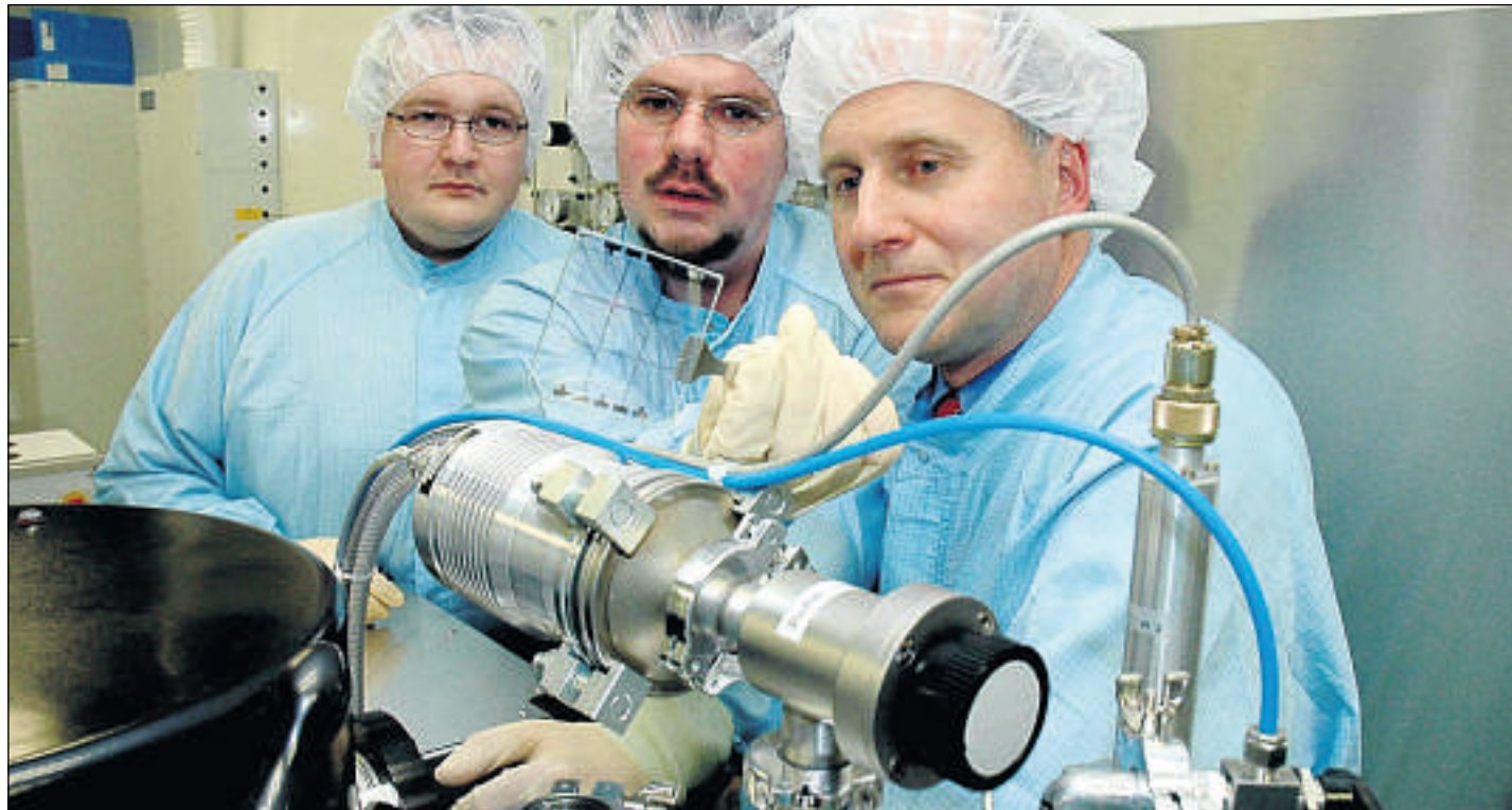
Nanospiegel: Mit seinen Assistenten Andreas Jäkel und Volker Viereck schaut sich Professor Hartmut Hillmer (von links) im Reinraum der Uni die Qualität eines Fenstermoduls (Mitte) an. Mit einer Ätzmachine (vorn) werden die Spiegel beweglich gemacht. Foto: Dilling
