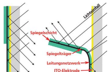
Bild 3: Schematische Darstellung eines Mikrospiegelementes (Querschnitt) in geschlossener (links) und geöffneter Position (rechts)
